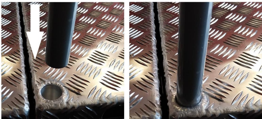
Obrázek č. 8 – Umístění tyče do otvoru na kufru
