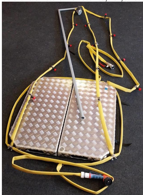
Obrázek č. 6 – Usazení rozvodů vody na tyčovou konstrukci
